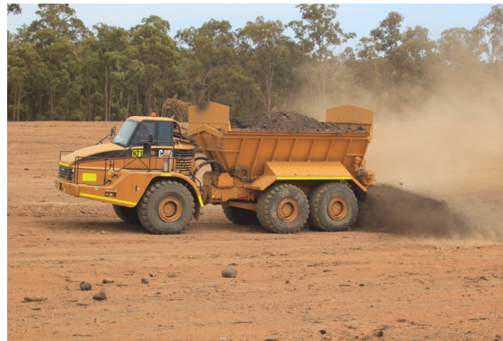
Figure 7.20 Épandage de terre végétale fraîche dans les installations d'Alcoa, Australie occidentale
